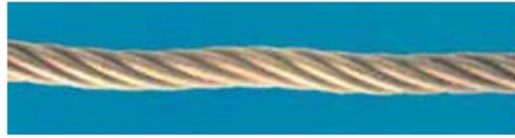
Deformasjon - Ståltau med gap
